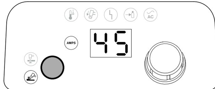
**2.** Одной рукой нажмите и удерживайте кнопку **Режим**. Другой рукой поверните рукоятку регулировки, чтобы установить требуемое значение давления газа. В этом примере мы снизили давление газа до 35 фунт/кв. дюйм.
