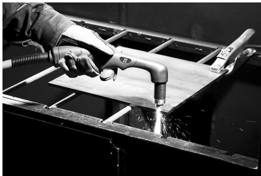
3. Для продолжения резки слегка проведите наконечником резака поперек заготовки. Поддерживайте постоянный и равномерный темп.
