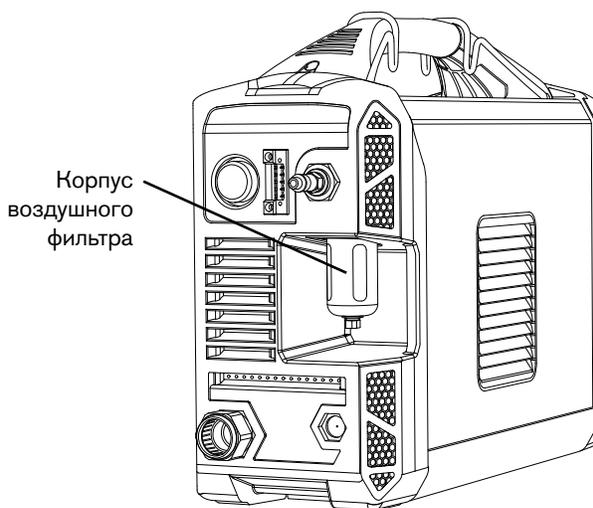
Встроенный воздушный фильтр не должен рассматриваться как замена соответствующей внешней фильтрации. При работе в средах с большой температурой и влажностью и на тех рабочих участках, на которых возможно попадание масла, паров или других загрязнителей в шланг подачи газа, установите внешнюю систему фильтрации, которая очистит подаваемый газ перед тем, как он поступит на источник тока плазменной резки.
