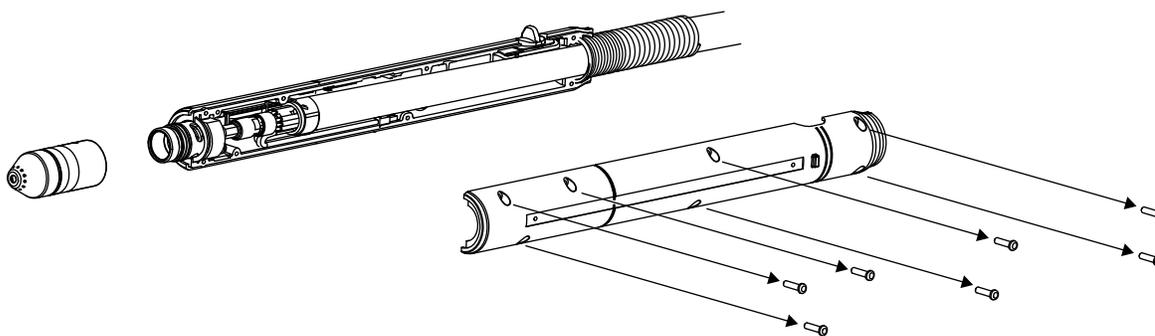
6. Снимите пластмассовый ползунок ① переключателя блокировки резака и отложите его в сторону.
