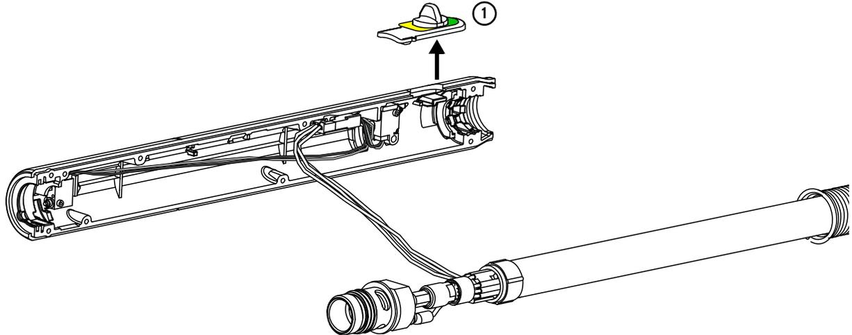
8. Отсоедините провода в правой оболочке. Нажмите выступ на разъеме провода, чтобы разъединить 2 части.
