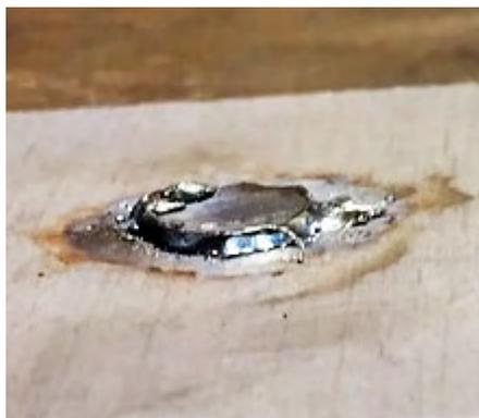
Точечный сварной шов снят
