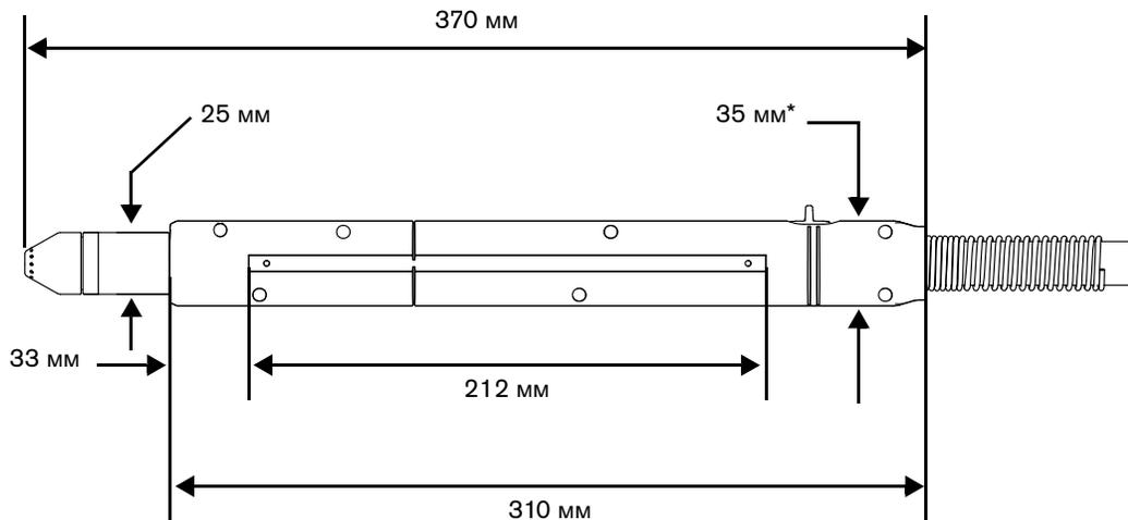
\* Это значение приведено для внешнего диаметра резака. Высота внешней оболочки резака составляет 41 мм с учетом переключателя блокировки резака.
