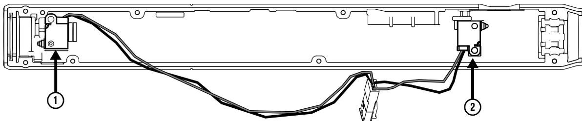
3. Подсоедините провода от корпуса резака ③ к проводам узла колпачкового датчика/переключателя блокировки резака ④.
