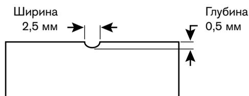
В следующих таблицах приведен профиль строжки с силой тока 10 А при углах наклона 40° и 50° на низкоуглеродистой стали. Эти настройки могут служить отправной точкой, помогая определить наилучший профиль строжки для данного задания. Отрегулируйте эти настройки для своего применения и стола, чтобы добиться желаемого результата.
