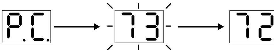
На дисплее отображается «P.C.» при входе в режим проверки газа.
