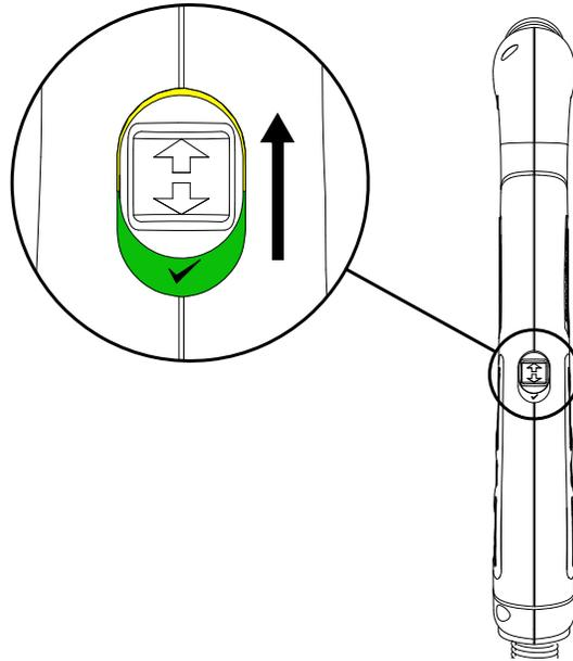
3. Отведите предохранительную крышку выключателя вперед (по направлению к головке резака) и нажмите красный выключатель резака.
