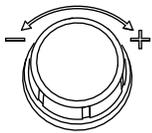
**Ручка регулировки** – Эта ручка регулировки позволяет установить значение текущего тока в диапазоне от 10 А до 45 А с шагом в 1 единицу.
