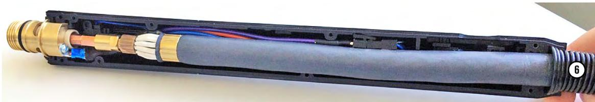
8. Переведите пластмассовый ползунок переключателя блокировки резака в обозначенную желтым цветом позицию блокировки (X).
