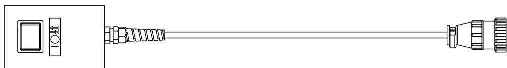
Подвесное устройство удаленного пуска позволяет дистанционно запустить и остановить механизированный резак. Например, используйте его, если резак установлен на простой направляющей или шаблоне для резки без собственного ЧПУ или другого контроллера.
