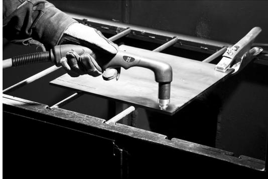
2. Нажмите выключатель резака, чтобы зажечь дугу. Задержите резак на краю, пока дуга не прорежет заготовку насквозь.
