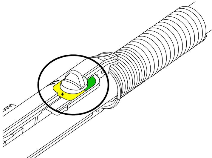
9. Закрепите левую половину оболочки резака на правой с использованием 7 винтов. Надежно соедините половины оболочки резака возле кабельного зажима и удерживайте их до установки винтов.
