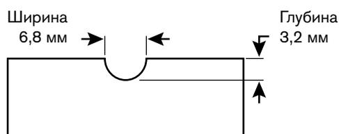
В следующих таблицах приведен профиль строжки с силой тока 45 А при углах наклона 40° и 50° на низкоуглеродистой стали и нержавеющей стали. Эти настройки могут служить отправной точкой, помогая определить наилучший профиль строжки для данного задания. Отрегулируйте эти настройки для своего применения и стола, чтобы добиться желаемого результата.
