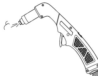
Продолжительность подачи защитного газа после гашения дуги зависит от режима работы и силы выходного тока. При определенных условиях она также зависит от подачи газа.
