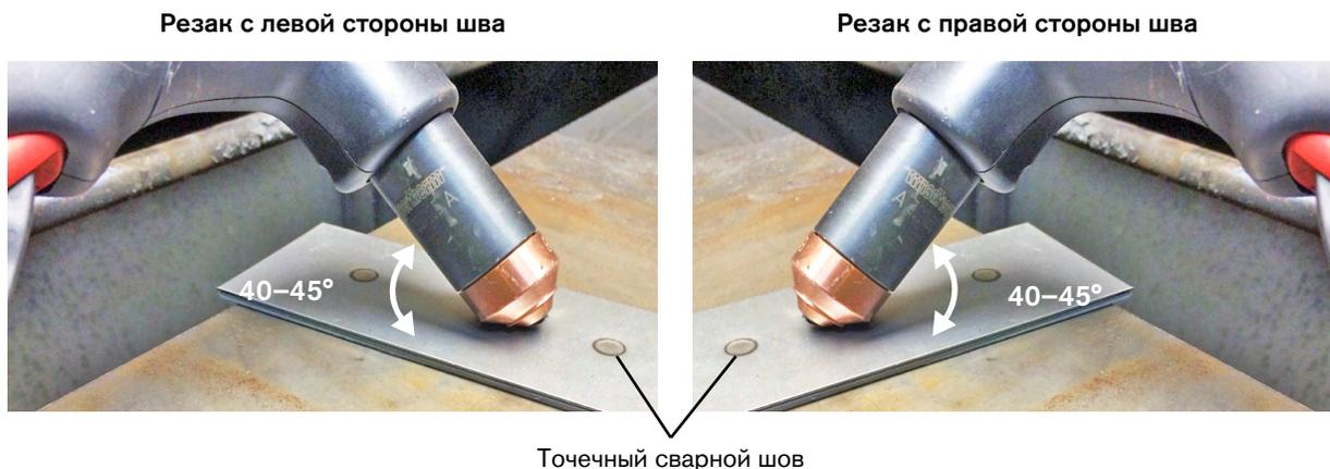
4. Нажмите выключатель, чтобы получить вспомогательную дугу. Перенесите дугу на заготовку, затем растяните ее приблизительно на 10–11 мм. Поддерживайте дугу, выполняя строжку.
