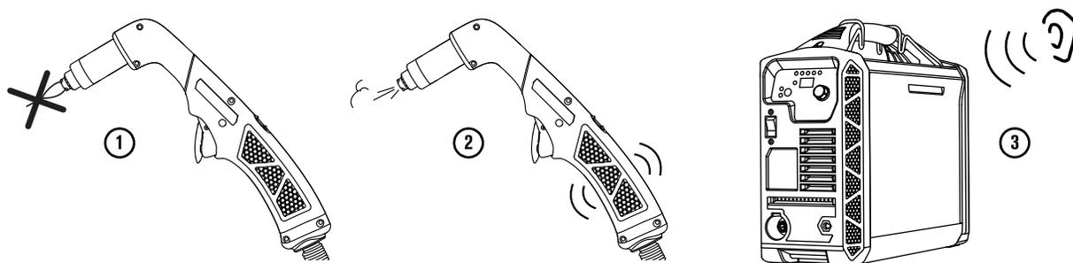
Такое поведение служит предупреждением. Оно не свидетельствует о сбое. Это служит для того, чтобы показать, что резак активирован и выполнит зажигание плазменной дуги при следующем зажигании резака.
