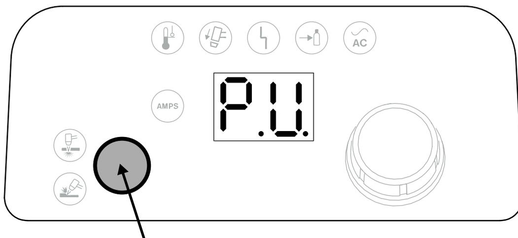
Нажмите и удерживайте на протяжении 15 с для переключения между **фунт/кв. дюйм** и **бар**.
