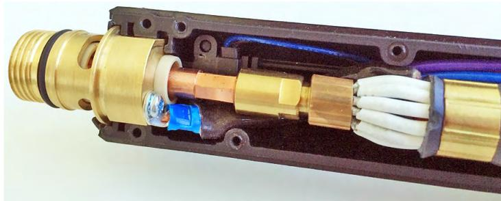
6. Остальной отрезок корпуса резака вставьте в правую половину оболочки, как показано на рисунке. При этом заделайте все провода в корпус резака. Не пережимайте или не загибайте провода. Убедитесь в том, что ни один из проводов не пролегает через отверстия для винтов в корпусе резака.
